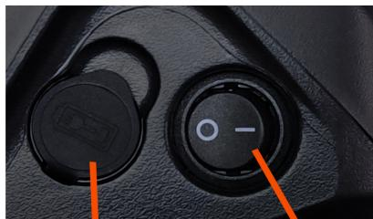
Gumová krytka nabíjecího konektoru      Kolébkový prepínač
