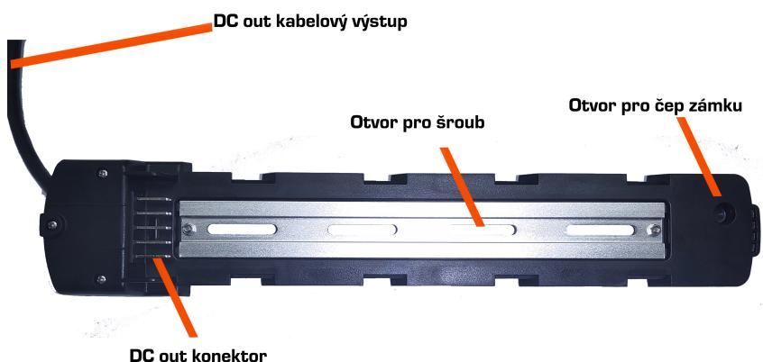
Dokovací plastová lišta se montuje do otvorů pro cykloláhev (použijte dostatečně dlouhé šrouby). Doporučuje se do rámu nechat (odborně) nanýtovat ještě třetí nýt a uchytit lištu doku na všechny tři šrouby pro pevnější uchycení. Přesto je třeba dbát při manipulaci s kolem zvýšené opatrnosti a zamezit rychlému působení hmotnosti akumulátoru do boku (zpravidla při pádu kola na bok), kdy by mohlo dojít k vytržení nýtů z rámu. Případné uvolňování nýtů v rámu je třeba pravidelně kontrolovat.
